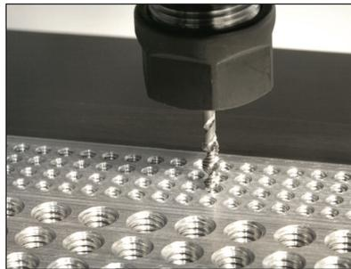
A árvore de transmissão direta em linha com cone BT30 incorporada da Haas disponibiliza 12.000 rpm para uma fresagem de alta velocidade; permite igualmente uma roscagem rígida a velocidades de até 5.000 rpm.
