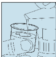
1. LP-Material in transparente Negativform füllen
