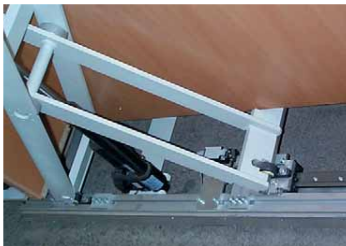
Bild 53.5: igubal®-Stehlager in Kombination mit DryLin® T-Lineargleitführung im Hebemechanismus
