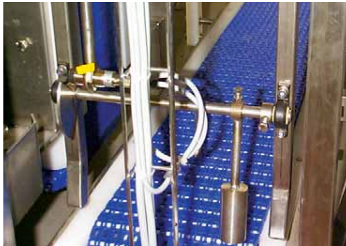
Bild 53.2: Einbaulage der igubal®-Stehlager in einer Förderanlage
