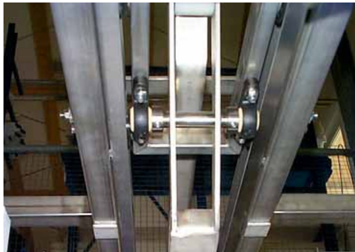
Bild 53.3: Weiteres Anwendungsbeispiel der igubal®-Stehlager in der Förderanlage
