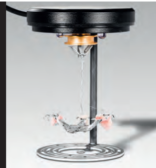
Die gereinigte und vorbereitete Arbeit im Galvanokopf kontaktiert
