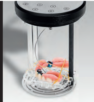
Die gereinigte und vorbereitete Arbeit im Galvanokopf kontaktiert
