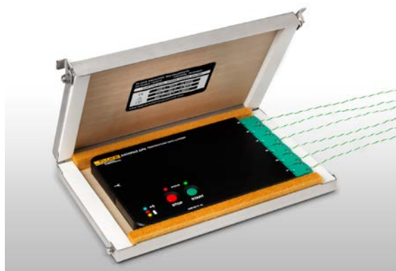
Registrador de datos Datapaq DP5 en una barrera térmica
