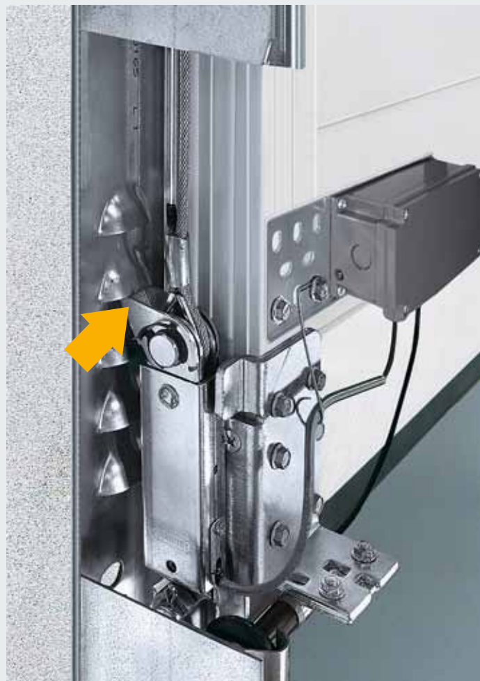
Cârligul setului de securizare ușă se blochează automat la ridicarea ușii.
