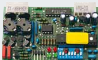
Analizator bucle de inducție Plăcuță cuplabilă cu 1 sau 2 canale. Adecvată pentru două bucle de inducție separate. Cablul pentru buclă nu este inclus în setul de livrare.
