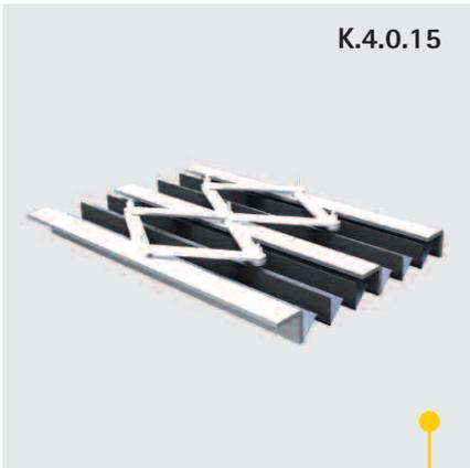
Scherensysteme gewährleisten den Gleichlauf einzelner Segmente. Zu beachten: Gewichtserhöhung kann Lmin und Dynamik einschränken.
