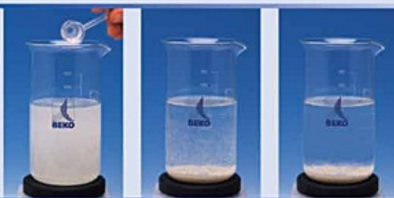
ตะกอนหรือฟล็อกซึ่งเกิดขึ้นจากการใช้เบนโทไนท์
