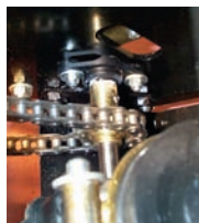
Łożysko kołnierzowe igubal® w wale maszyny sprzątającej
