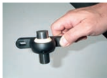
Testowanie tolerancji ze sprawdzianem średnicowym.
