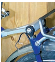
Głowice przegubowe igubal® w mechanizmie tylnego zawieszenia roweru
