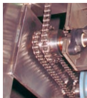
Łożysko kołnierzowe igubal® w napędzie przenośnika pasowego
