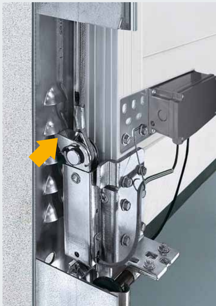
Zatrząsk ryglujący w kształcie haka blokuje się automatycznie przy próbie podważenia bramy.
