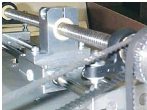
Abb. 67.1: iglidur®-Trapezgewindemuttern sind die ideale Ergänzung zu DryLin®-wartungsfreien Linearlagern
