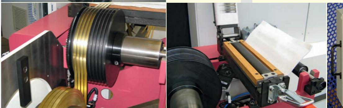
Systèmes enrouleurs pour matériaux fins: Enroulement avec angle constant
