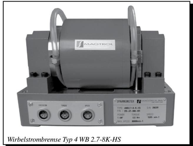
*Wirbelstrombremse Typ 4 WB 2.7-8K-HS*
