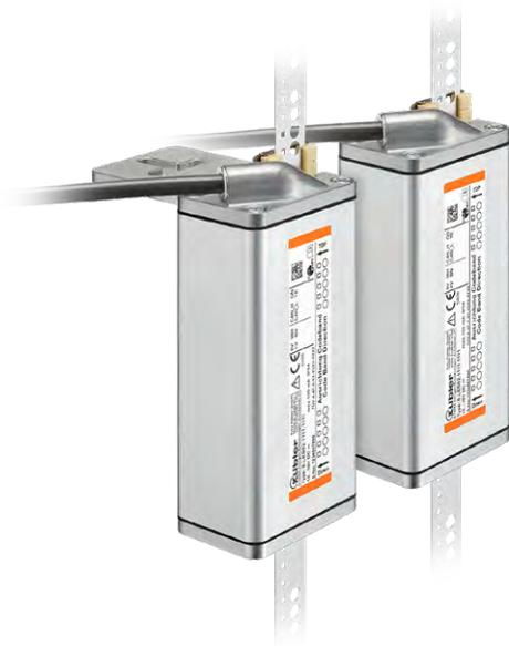
LEB02 ist ein extrem robustes, kompaktes und berührungsloses Messsystem. Mit einer Auflösung von 1 mm und einer Verfahrgeschwindigkeit bis 8 m/s werden absolute Positionswerte des Fahrkorbes über ein berührungsloses Messprinzip schlupffrei ermittelt. Zusätzliche Komponenten wie Magnetschalter werden überflüssig.
