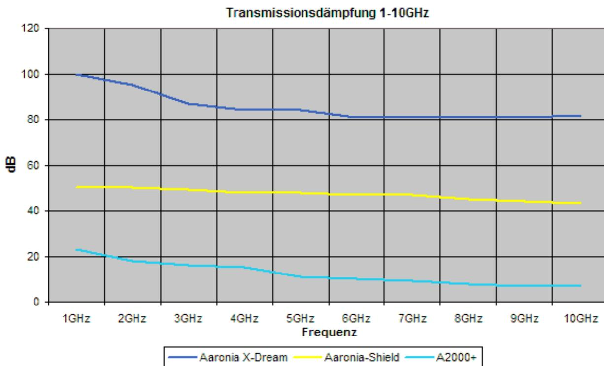
Messungen bestätigen die gute Abschirmleistung: Die Verringerung/Dämpfung von Hochfrequenzstrahlungen insbesondere im Bereich von GSM, UMTS und WLAN (900MHz-2,5GHz), beträgt 90% bis 99%. Auch statische und niederfrequente elektrische Felder, wie sie alle Kabel und Zuleitungen von elektrischen Geräten oder Hochspannungsleitungen abstrahlen, werden um bis zu 99,9% verringert.
