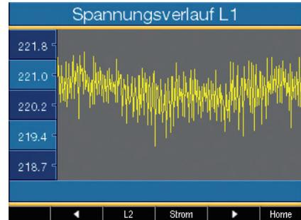
Abb.: Farbige Grafikdisplay – Beispiel Spannungsverlauf
