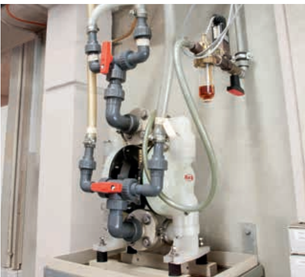
FDM: Fördern von Chemisch Nickel zum Ansatz eines galvanischen Beckens.
