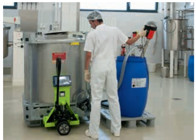
F 560 GS im Hygieneinsatz – Fördern von Cremegrundstoff in ein Mischbehältnis.
