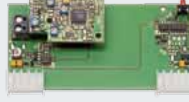
Alıcı HER 1 (1-Kanal) Münferit gövde, voltajsız röle çıkışlı, bağlantı kablosuz veya kumanda panosunda soketli kart olarak
