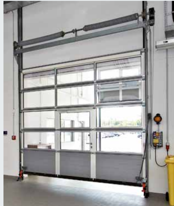
İç kısmı renkli olan kapılar için kapı kanadı takviyesi ve panellerin uç köşebentleri sadece kırli beyaz renginde sunuluyor, RAL 9002. Personel kapısı içinde olan garaj kapılarının personel kapının çerçevesi iç tarafta alüminyum profillerden oluşmaktadır, E6 / C0 (daha önce E6 / EV 1).
