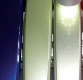
▲ Farbkontrolle unterschiedlich lackierter Blenden
