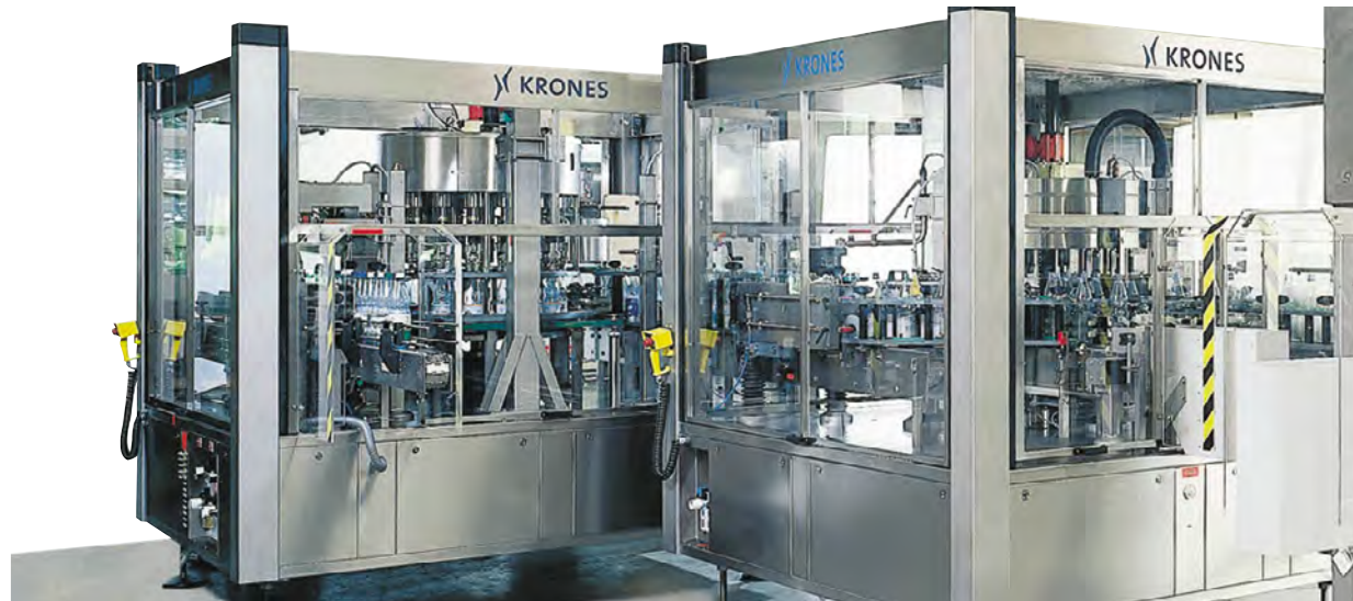
Abschrauber Rotomat (links) und Entetikierer (rechts) im Bloc
