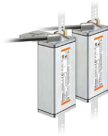
Ants LEB02 est un système de mesure extrêmement robuste, compact et sans contact. Grâce à son principe de mesure sans contact, il mesure, sans glissement, les positions absolues de la cabine avec une résolution de 1 mm et une vitesse de déplacement de 8 m/s. Les composants supplémentaires comme les commutateurs magnétiques ne sont plus nécessaires.
